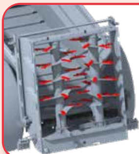
Szeroka naprzemienna praca wałków (szerokość zależna od materiału): 7 m (standard) lub 8 m z zębami łopatkowymi.
