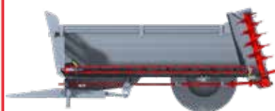
Wał napędowy pod obniżoną osią (idealny na pochyłym terenie).
